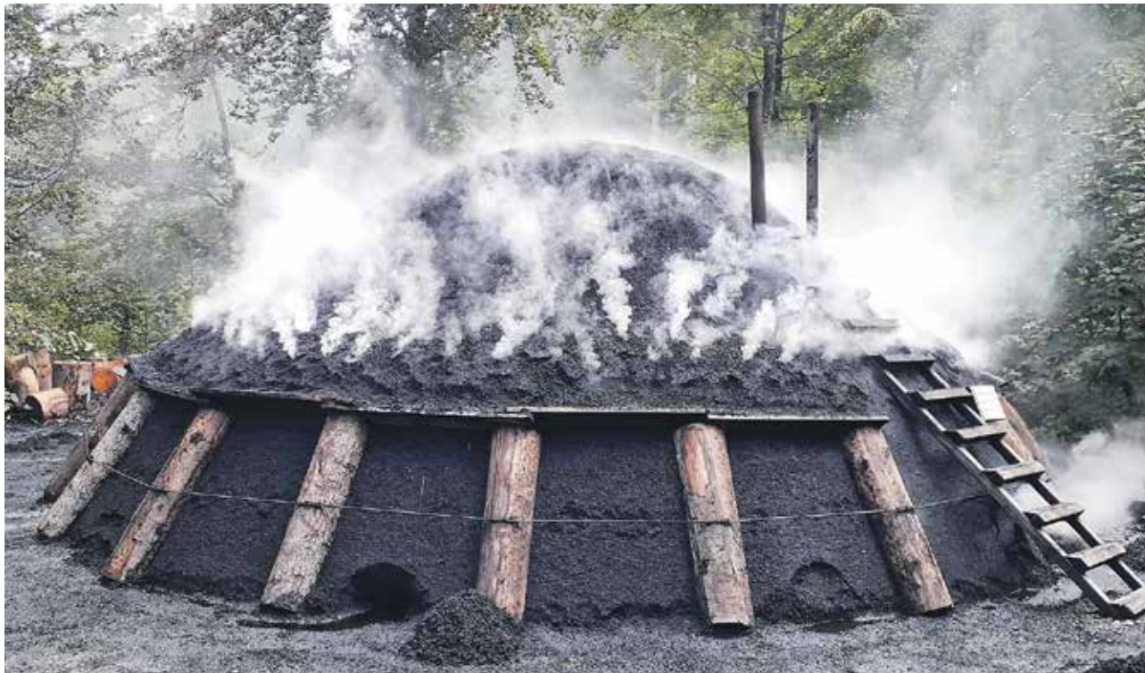
Der Meiler kühlt von oben nach unten durch. Nach circa zwölf Tagen erreicht die Verkohlung die untersten Schichten.
